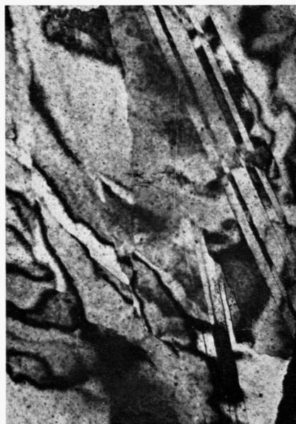
Abb. 3. Umkristallisation von InSb-Aufdampfschichten nach intensivem Elektronenbeschuß zu ausgedehnten Kristall lamellen (30 000 \times ), 3 mm \geq 0,1 \mu .
